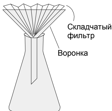
Рис. 3.3. Фильтрация горячего раствора через складчатый бумажный фильтр
