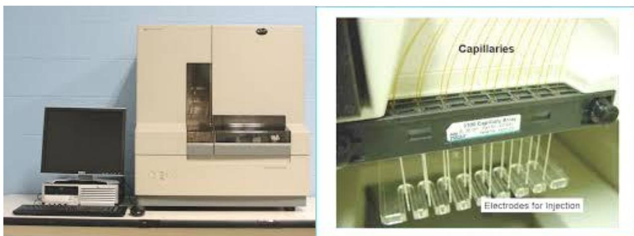
*Рис. 53.* Секвенатор ABI PRISM® 3100 Genetic Analyzer:
